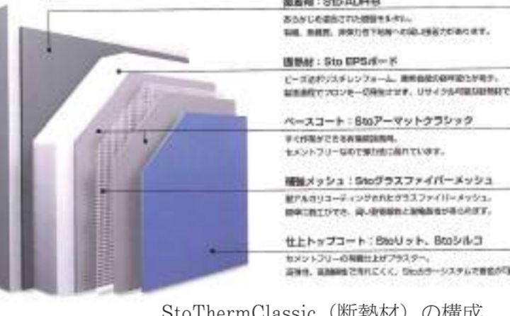
StoThermClassic (断熱材) の構成
